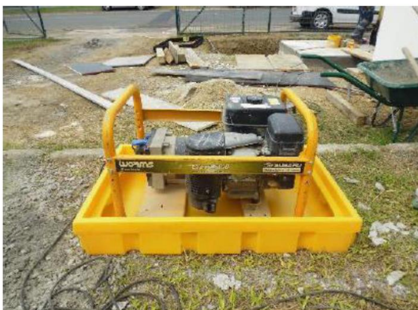
Bac de rétention pour groupe électrogène
